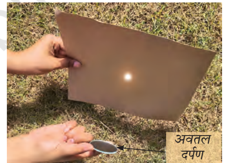
चित्र 10.12 — अवतल दर्पण द्वारा सूर्य के प्रकाश को कागज पर अभिसरित करना
